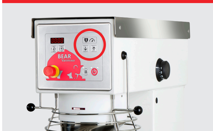
VL-1S – Automatisk hastighetsreglering och automatisk sänkning av kitteln
